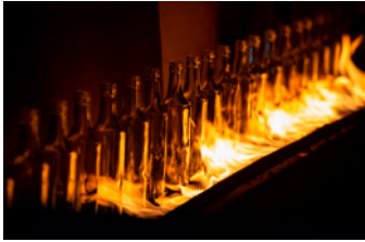
Sklárne tvarovanie, triedenie, preprava a chladenie skla potrebný tlak 3-4 bar
